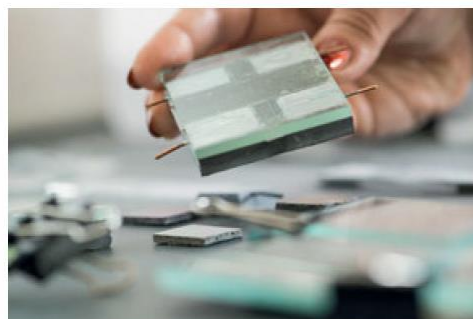
شکل ۶: مفهوم بتن خورشیدی حساس به رنگ: سلول 5*5 سانتی متر (©2019 Bau Kunst Erfinden)
