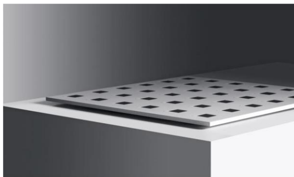
شکل ۳ نمونه اولیه عنصر نمای بتن خورشیدی حساس به رنگ سانتی متر در (100*100 سانتی متر) (©2019 Bau kunst Erfinden : photo:haw-lin)
