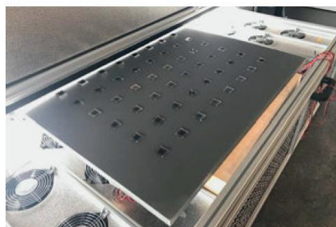
شکل ۷: مفهوم بتن خورشیدی حساس به رنگ: تست راه اندازی (©2019 Bau Kunst Erfinden)
